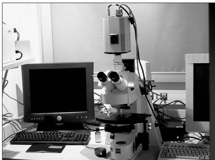
**Figure I. Microscope de recherche.** Un microscope de recherche droit qui est équipé d'une caméra CCD. L'ensemble du système est contrôlé par ordinateur. Ce système de microscopie permet d'acquérir des images en lumière transmise ou en fluorescence (microscope de la plate-forme d'Imagerie Dynamique de l'Institut Pasteur, photo par S. SPRAY).
